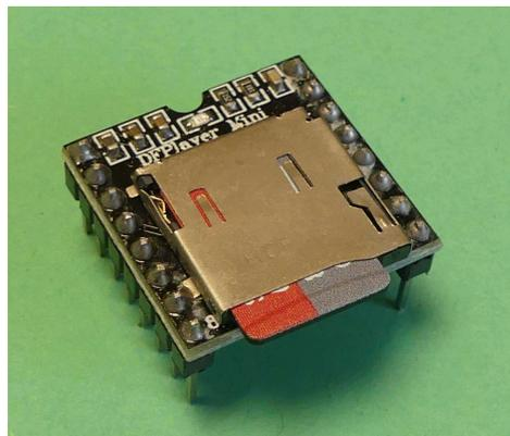
L'ampli intégré à peine visible, de type "PWM", est donné pour une puissance de 3W
